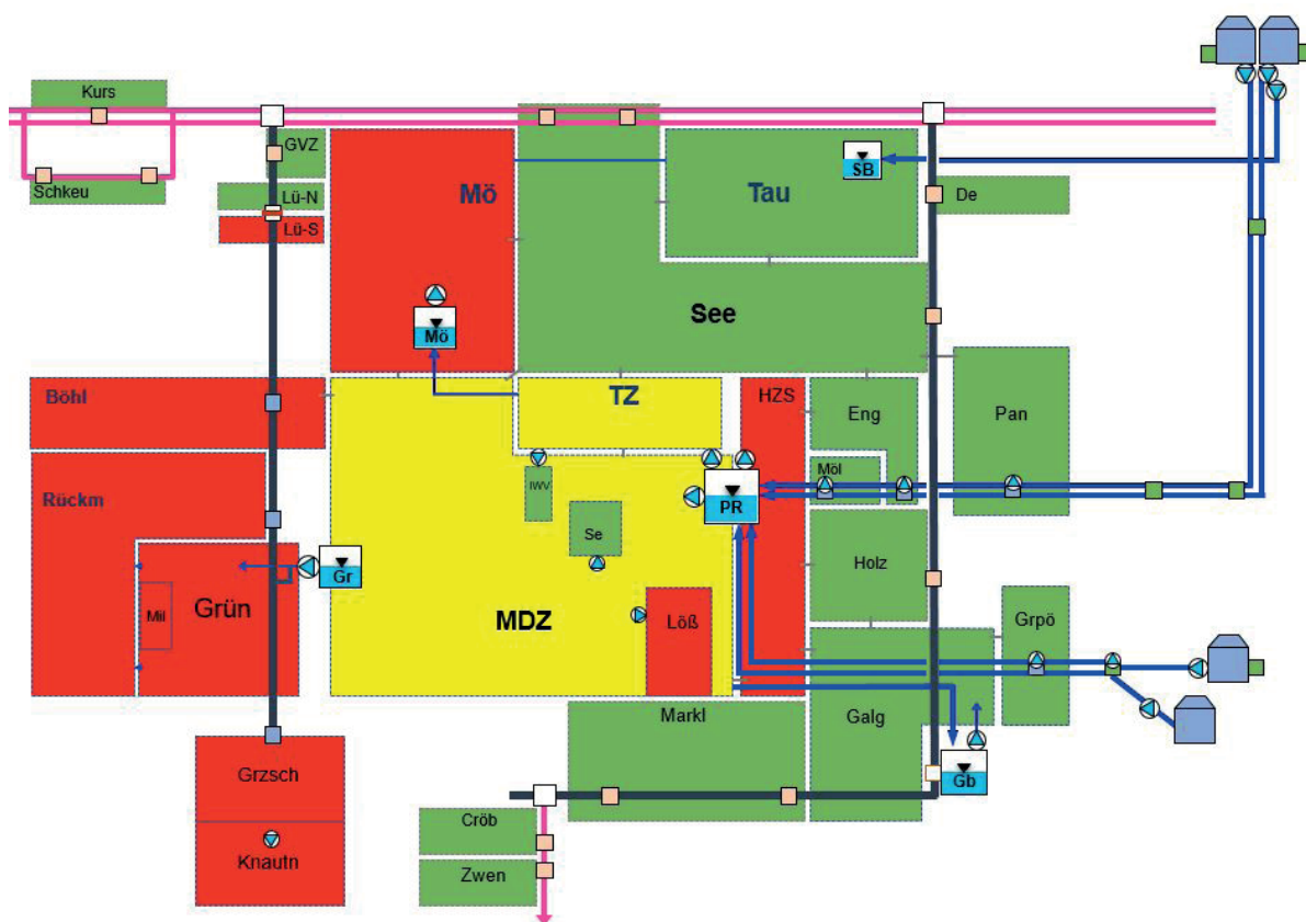
Bild 3: Schadensausmaß nach 24 Stunden ohne Aktivierung von Gegenmaßnahmen
